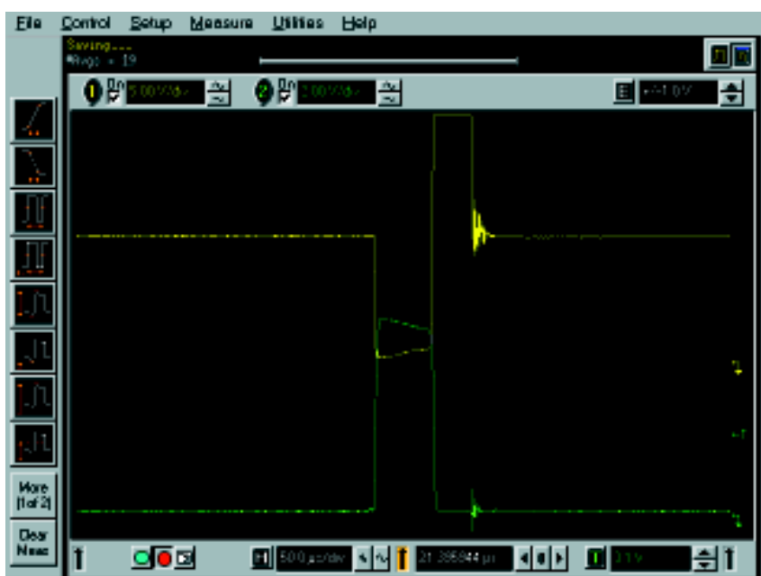
Rys. 6. Przebieg sterujący bramkę T1 (na dole) i odpowiedź na jego drenie (u góry).
